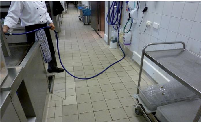
Abb. 9: Stolperstelle durch einen im Verkehrsweg liegenden Schlauch
