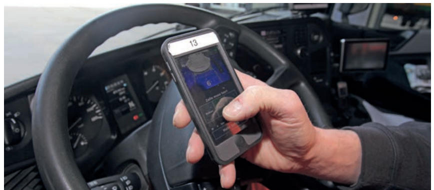
Auf dem Display des PDA sieht der Lkw-Fahrer die Siloöffnungen seines Fahrzeugs und bringt es jeweils genau unter der Verladegarnitur in Position.
