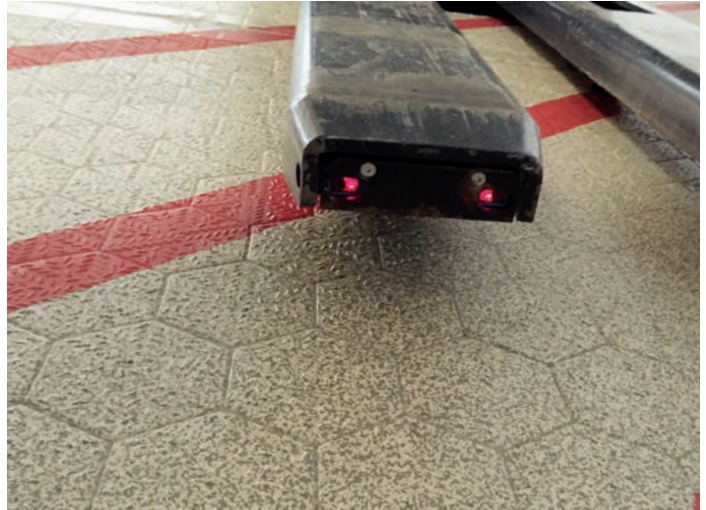
Nicht als Schutzeinrichtung ausgelegte Näherungssensoren milderten die Unfallfolgen.
