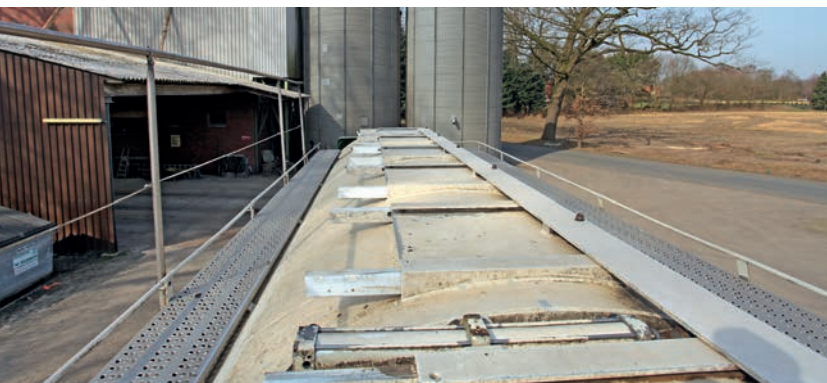
Raker Landhandel: Bei diesem Silofahrzeug öffnen und schließen die Domdeckel pneumatisch.
