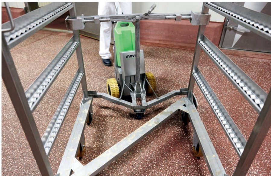
Über einen Hebelmechanismus lassen sich mit den oberen Greifarmen die Rauchwagen arretieren.
