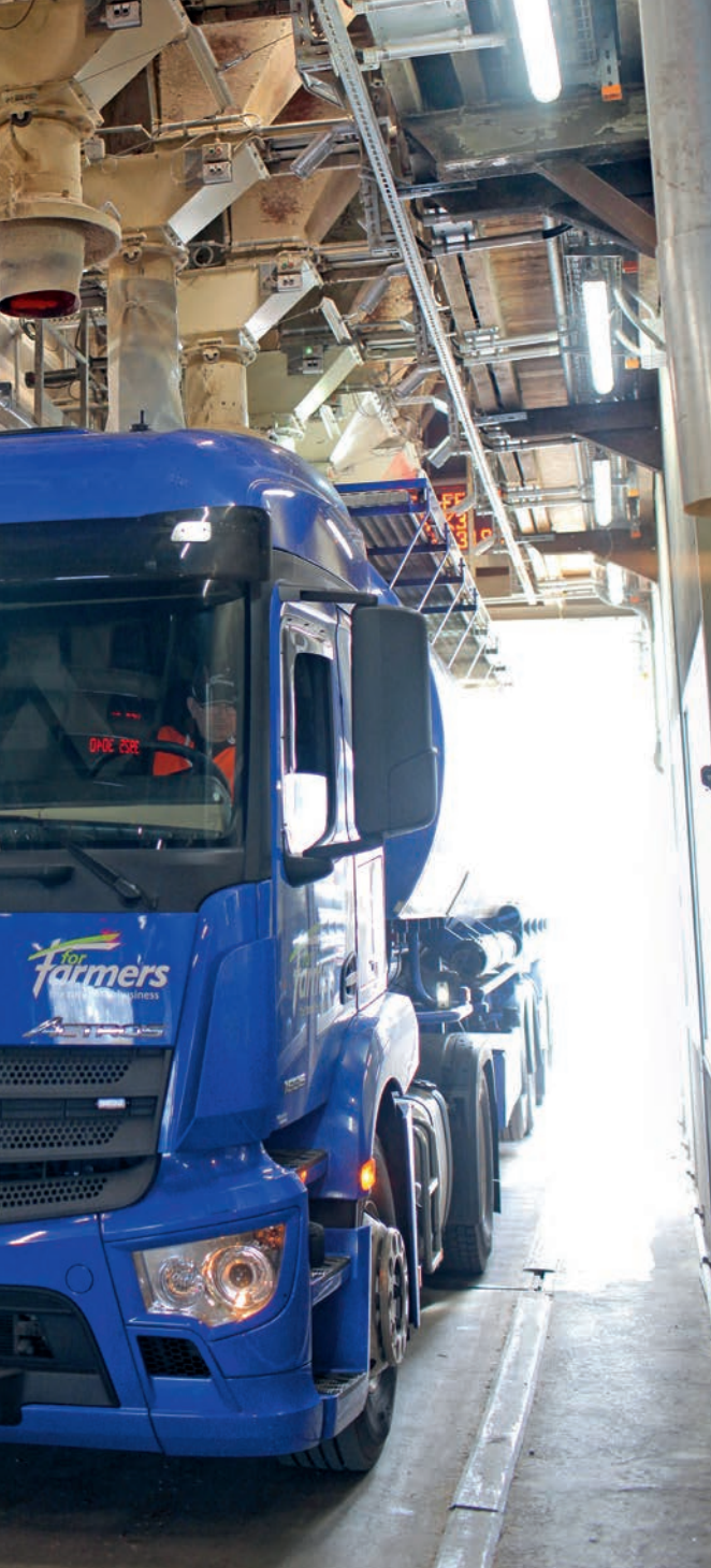
ForFarmers: Kamera- und PDA-überwachte Verladung vom Führerhaus aus. Die Domdeckel öffnet und schließt der Fahrer außerhalb der niedrigen Verladegasse bei aufgestelltem Geländer.
