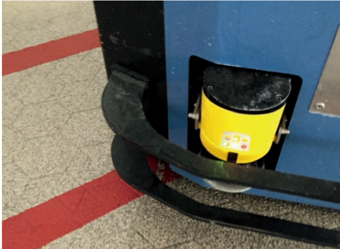
Laserscanner zur Personenerkennung an der Vorderseite des FTF
