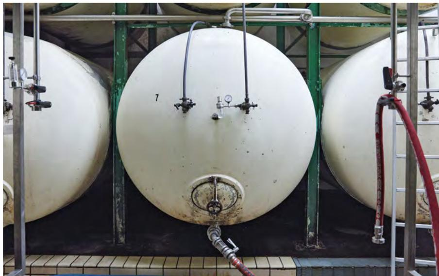
Über die Gelägerleitung gelangt das CO<sub>2</sub>-Gemisch in einen ausgedienten kleinen Tank, der als Abscheider dient und dessen Domanschluss mit einer Leitung ins Freie verbunden ist.
