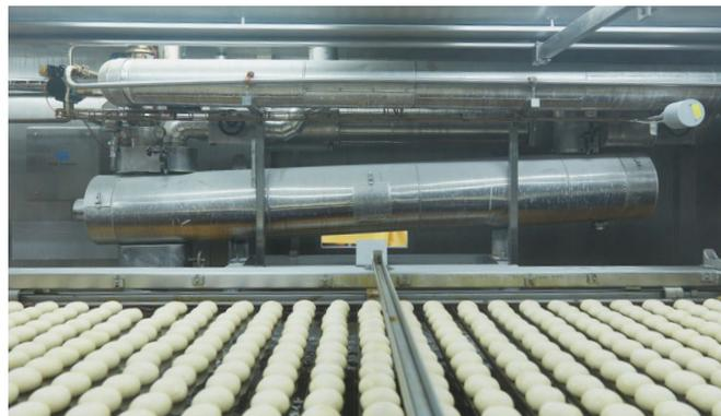
Das Erhitzen des Frittieröls erfolgt indirekt mittels Wämetauscher (im Hintergrund). Die Frittieröltemperatur in der Fettbackwanne wird so immer zwischen 165 und 173 °C gehalten.
