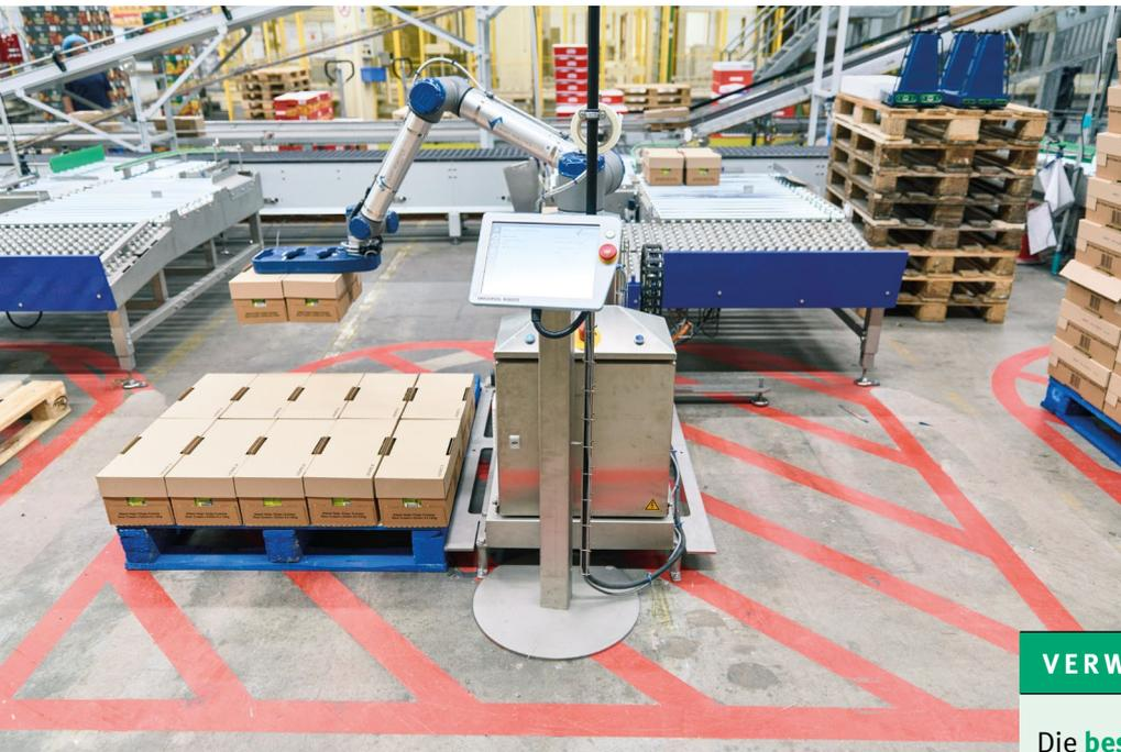
Gekennzeichneter maximaler Arbeitsbereich des Cobots
