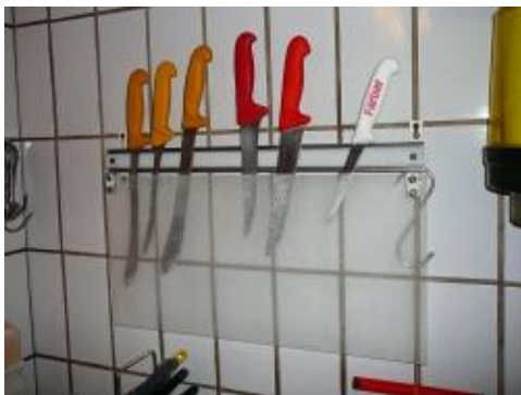
Bild 1: Magnet-Messerhalterung mit Schutzscheibe
