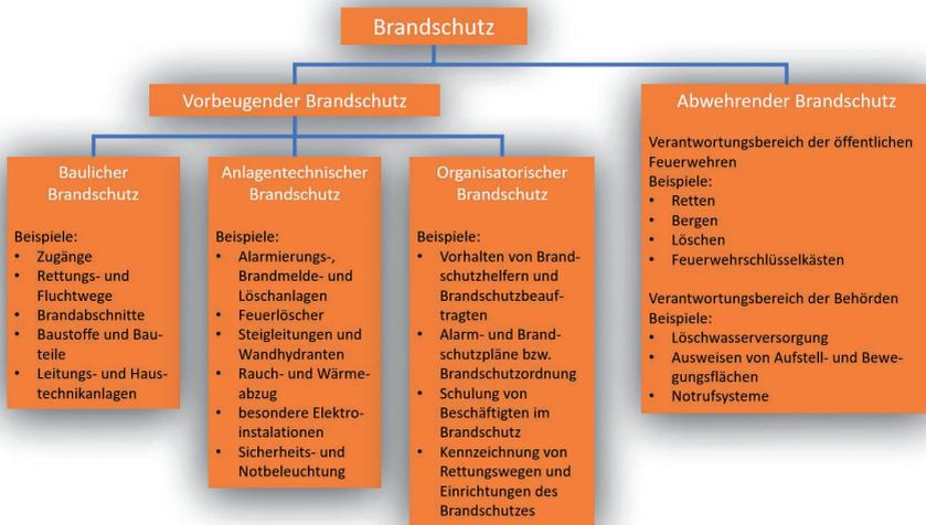
Abb. 2: Schematische Darstellung der Einteilung des Brandschutzes in vorbeugenden und abwehrenden Brandschutz
