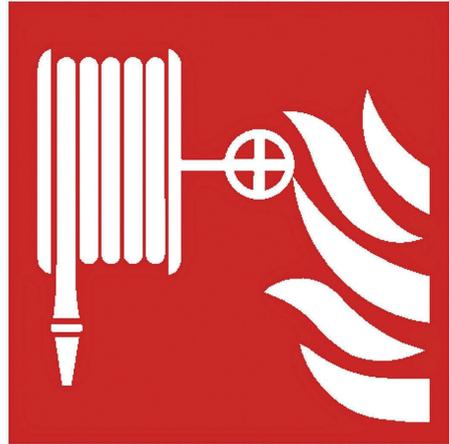
Abb. 17: Brandschutzzeichen F002 „Löschschlauch“ auch Wandhydrant genannt.
