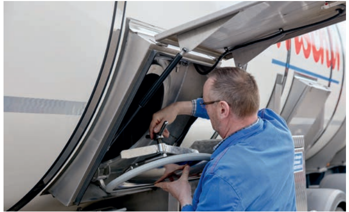
Zur Inspektion lässt sich der Tankdeckel bequem vom Boden aus öffnen und komplett abnehmen.
