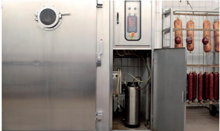
// Räucheranlagen müssen nach Vorgabe des Herstellers in regelmäßigen Abständen – mindestens jedoch halbjährlich – durch eine zur Prüfung befähigte Person geprüft werden. In der Regel übernimmt diese Prüfung die Herstellerfirma oder ein Wartungsunternehmen.
