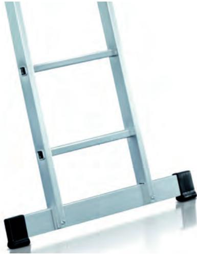
// Wer eine neue Leiter kauft, die als Anlegeleiter genutzt werden kann und länger als 3 Meter ist, sollte darauf achten, dass sie am Fußende eine Standverbreiterung (Quertraverse) besitzt. Sie erhöht die Seitenstabilität und Standsicherheit der Leiter.
