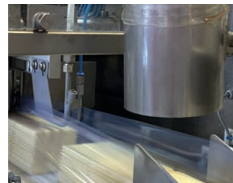
An den Ein- und Auslauföffnungen wird das Gasgemisch abgesaugt.
