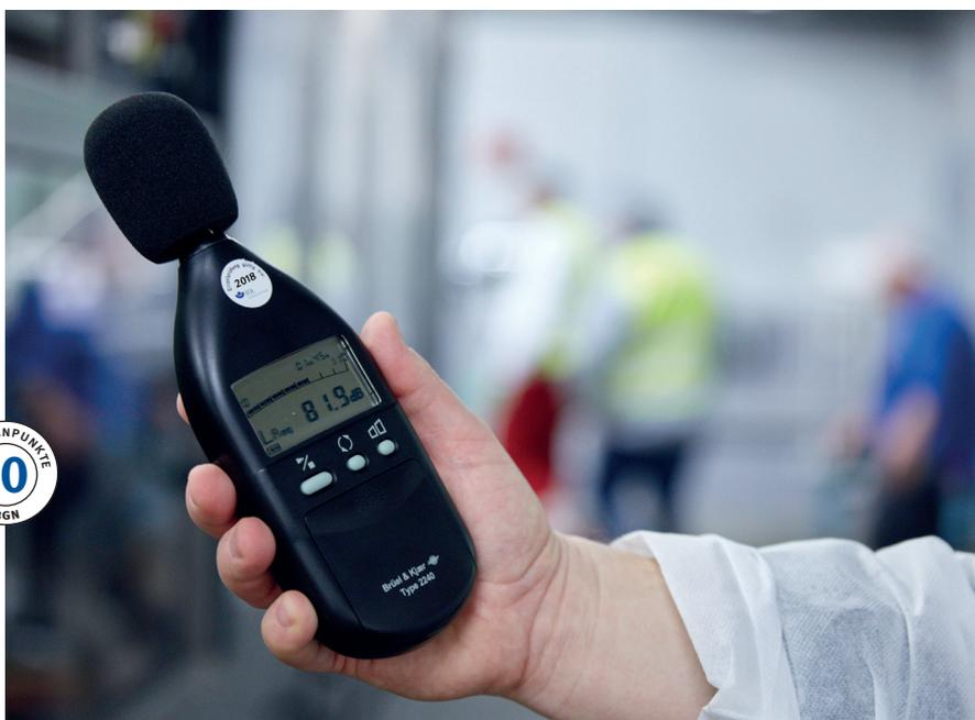
Die BGN erprobt derzeit ein in Fachkreisen bekanntes vereinfachtes Verfahren (Nahfeldverfahren), um die Schallleistung zu ermitteln. Dazu führt sie ein Modellprojekt im Rahmen des Prämienverfahrens durch. Projektziel ist, das Verfahren zu validieren und es für Anlagenhersteller und -betreiber anwendbar zu machen.
