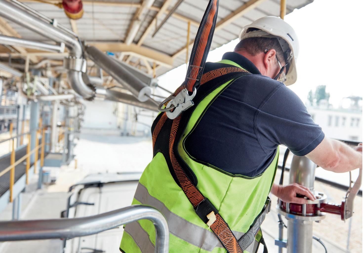
Auf Verladebrücken bietet ein Auffanggurt an einem Höhensicherungsgerät dem Verladepersonal zusätzlichen Schutz.
