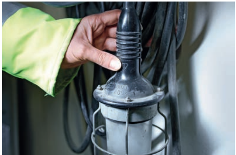
Die Handleuchte (Bild nur zur Illustration) hatte sich vermutlich im Behälterinneren in einer Leitersprosse verhakt. Das Ziehen am vorgeschädigten Kabel führte zum Abriss.
