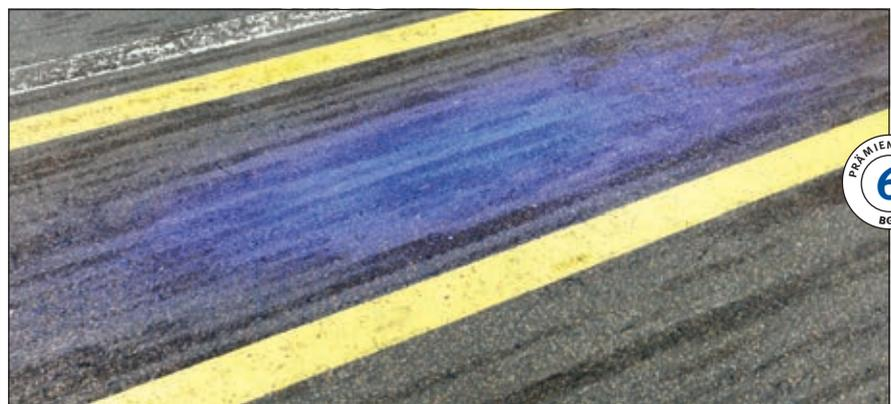
Das Bild zeigt einen blauen Lichtpunkt (Blue Spot) auf einem Hallenboden, der Fußgänger vor einem herannahenden rückwärtsfahrenden Gabelstapler warnt. Das blinkende Licht stammt aus einem Blaulicht-Scheinwerfer, der am Dach des Staplers montiert und mit dem Blinkgeber gekoppelt ist. Die BGN vergibt für ein solches Frühwarnsystem 6 Prämienpunkte.
