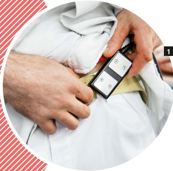
1 | Die Kombination von Kamera- und Kurzschlussystem sorgt für extrem schnelle Stoppzeiten des Sägebandes – und maximale Arbeitssicherheit.
