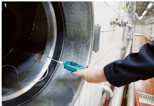
1 | Messung der Sauerstoff- beziehungsweise Gaskonzentration mithilfe eines Gasmessgeräts, dessen Schlauch weit in den Tank hineinreicht. So kann auch tief im Behälter gemessen werden.
