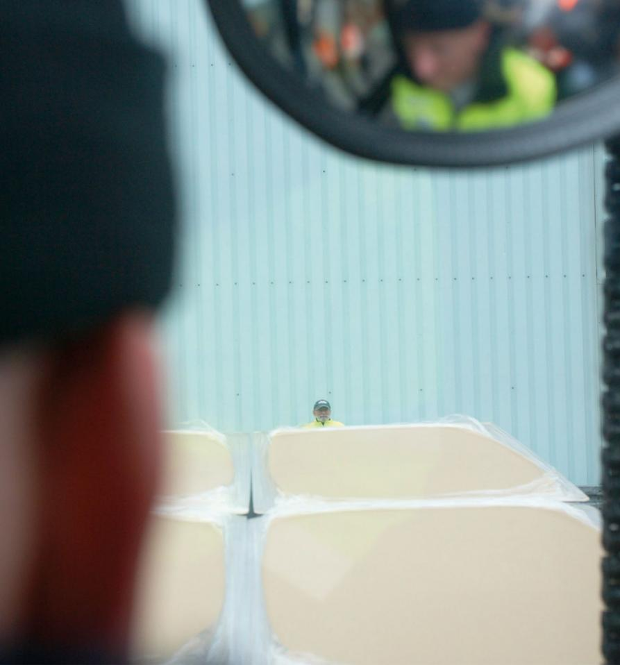
Ein BGN-Experiment ergab: Ein Staplerfahrer, der eine 2,40 m tiefe und 1,70 m hohe Last geladen hat, kann Kopf und Schultern eines Fußgängers auf dem Fahrweg erst in ca. 8 m Entfernung sehen. Wer näher am Stapler dran ist, befindet sich im toten Winkel.
