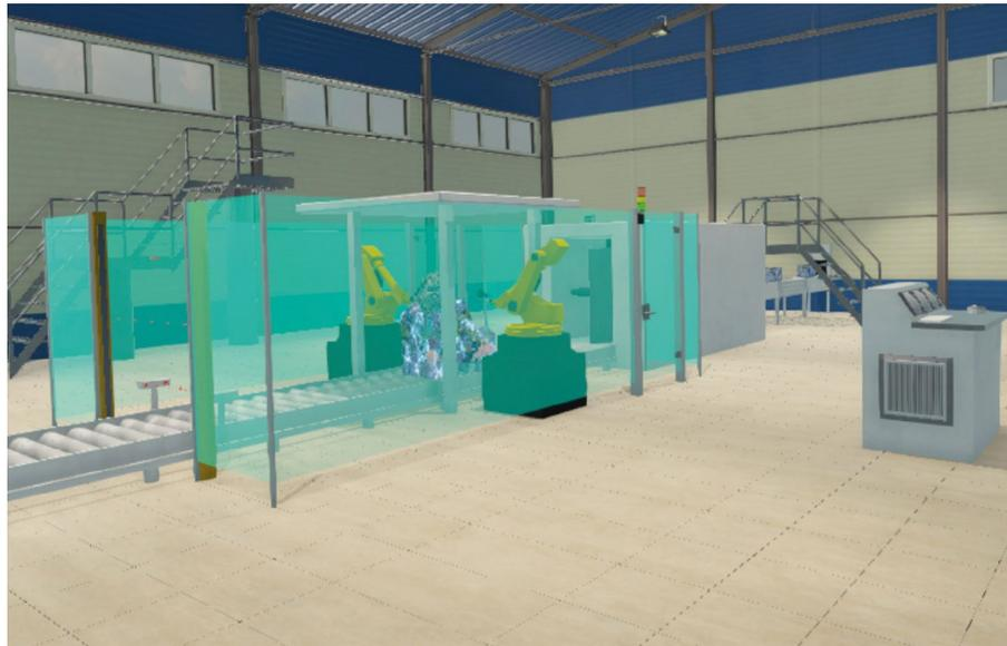
An dieser virtuellen Maschinenanlage üben Teilnehmer in BGN-Seminaren die Durchführung einer Risikobeurteilung und die anschließende Risikominderung. Die hier dargestellte Anlage ist bereits mit einigen Schutzeinrichtungen ausgestattet.
