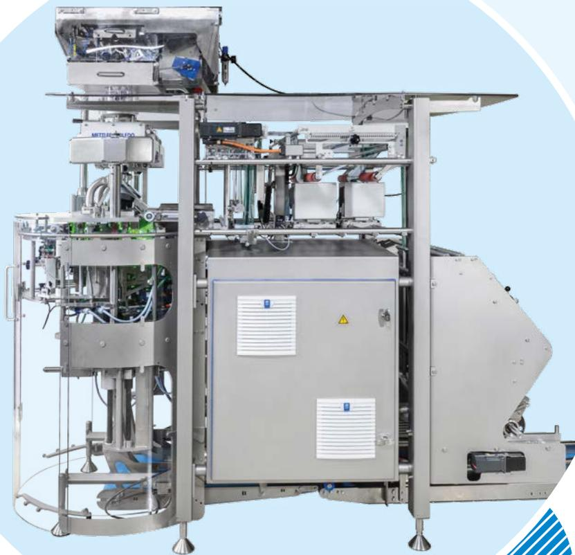
1 | Siegelstation einer vertikalen Schlauchbeutelmaschine
