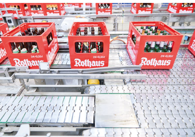
Bild 4: Optimierung des Gebindetransports, hier Bandübergang mit jetzt ausge- glichener Höhen- differenz
