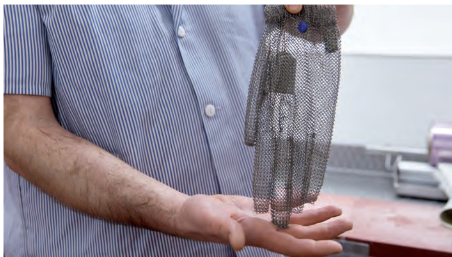
Handschuh aus Titan: 40 % leichter als ein Metallringgeflecht-Handschuh. Außerdem: geringeres Kältegefühl, für bestimmte Allergiker geeignet.
