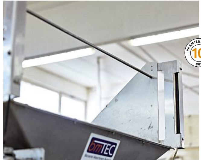
Teigteiler mit beidseitigem Lichtgitter oberhalb des Trichters
