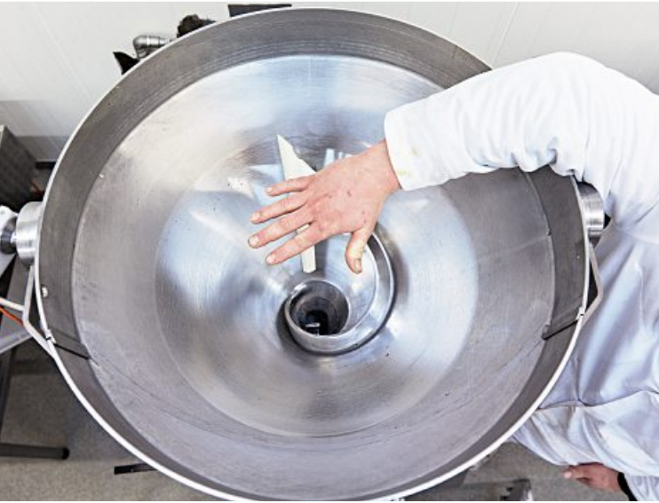
Bild 1: Gefährlich und verboten: Eingriff in die laufende Maschine bei nicht abgeklapptem oberem Trichterteil.
