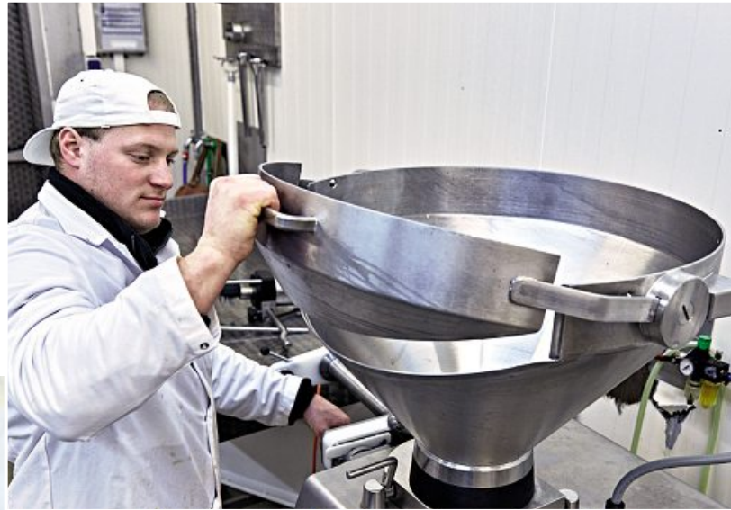
Bild 2: Sobald der obere Trichterteil abgeklappt wird, schaltet die Maschine ab.
