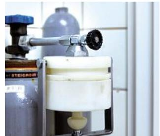
Zur Herstellung der Trockeneistablette wird flüssiges unter Druck stehendes Kohlendioxid (CO<sub>2</sub>) aus einer Druckgasflasche in eine spezielle Kunststoffform eingelassen. Unter Umgebungsdruck entspannt sich das CO<sub>2</sub> und gefriert zu Trockeneisschnee, der dann in Tablettenform gepresst wird.
