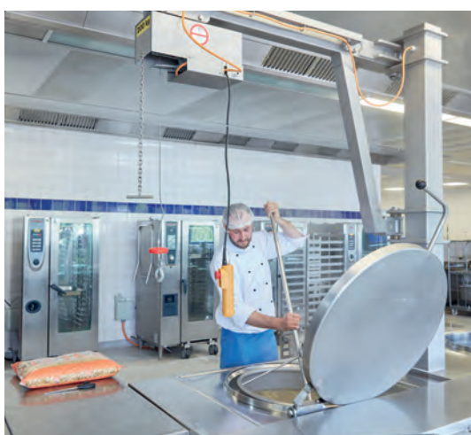
Während des Kochens bleibt das Sieb im Kochkessel. Die Hebevorrichtung ist zur Seite geschoben.
