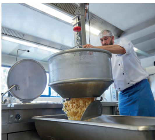
Nach der Schnellkühlung im Eisbad wird der Siebboden aufgeklappt, die Nudeln rutschen in die bereitstehende Wanne.
