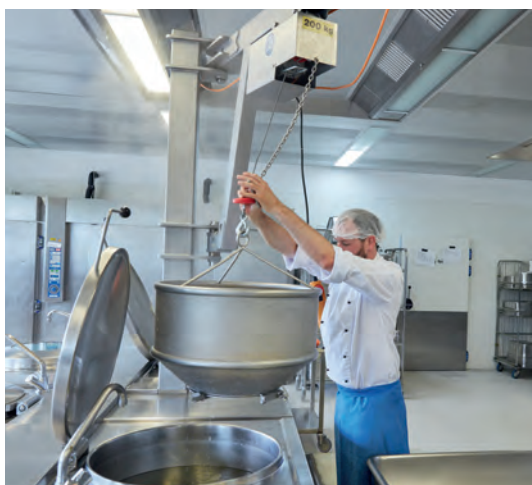
Mithilfe des Schwenkarms wird das Sieb mit den gekochten Nudeln zum Kochkessel mit Eiswasser umgesetzt.
