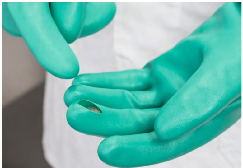
Der Gummihandschuh bietet keinen Schutz vor den Messern, der darunter getragene Spezialhandschuh schon. Bei Metallkontakt schaltet die Maschine ab.
