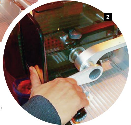
**2 | So wird's gemacht:** Der Daumen bleibt bei jeder Schneidebewegung hinter der breiten Schlittenrückwand. Damit kann – auch wenn Wurstreste mit den Fingern gehalten werden – nichts passieren.
