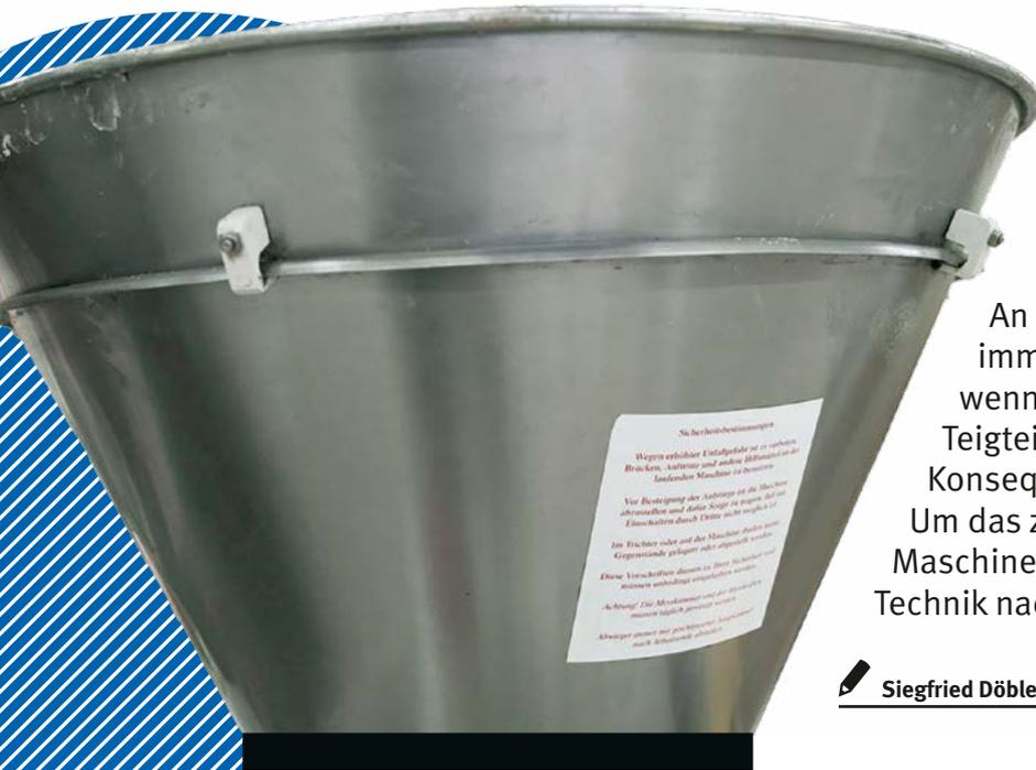
An Brot-Teigteilmaschinen kommt es immer wieder zu schweren Unfällen, wenn Beschäftigte in den Trichter zur Teigteileinrichtung greifen. Häufige Konsequenz: Amputation von Gliedmaßen. Um das zu vermeiden, müssen diese Maschinen entsprechend dem Stand der Technik nachgerüstet werden.
