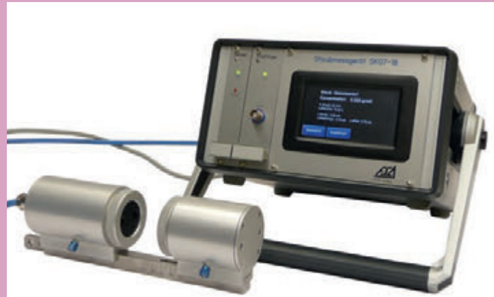
Im Zentrallabor der BGN entwickeltes optoelektronisches Staubkonzentrationsmessgerät
