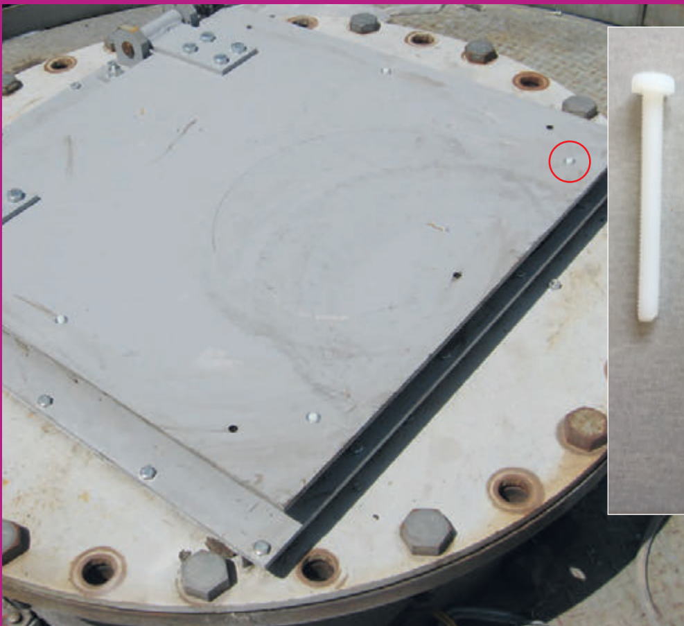
Polyamidschrauben der Größen M6, M8 und M10
