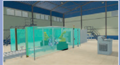
An dieser virtuellen Maschinenanlage üben Seminarteilnehmer die Durchführung einer Risikobeurteilung und Risikominderung. Die dargestellte Anlage ist bereits mit einigen Schutzeinrichtungen ausgestattet.
