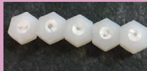
Die BGN/FSA-Untersuchungen ergaben, dass ein erheblicher Teil der Polyamidschrauben diverse Fehlstellen im Schraubenkörper aufweist.
