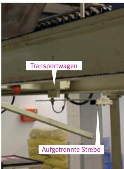
letzt. Sie war mit Hilfe einer Leiter in den Gefahrenbereich eingestiegen, vermutlich um eine Störung zu beseitigen. Wahrscheinlich wollte sie überhängende Bonbonmasse zurück in den Trichter des Transportwagens befördern. Als der Transportwagen für sie unerwartet anfuhr, drückte er sie gegen die erste Querstrebe der Schienenhalterung. Ihr Brustkorb wurde eingequetscht.
