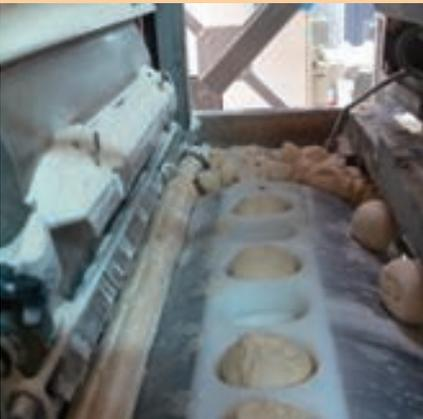
Der Teigtransport in der Teigteilmaschine hatte nicht optimal funktioniert. Dadurch blieb überschüssiger Teig im Bereich der Antriebseinrichtungen über einer Auffangschale kleben. Die Schutzabdeckungen des Kettentriebs waren unzureichend.
