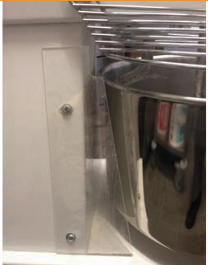
Bei diesem Maß besteht jedoch eine erhebliche Einzugsgefahr, wenn bei laufender Maschine der Bottich im Bereich des Maschinengehäuses gereinigt wird.
