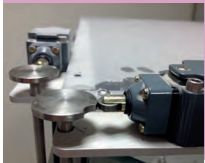
Positionsgeber an der geöffneten Schutztür der Bedienerseite – zum Unfallzeitpunkt demontiert
