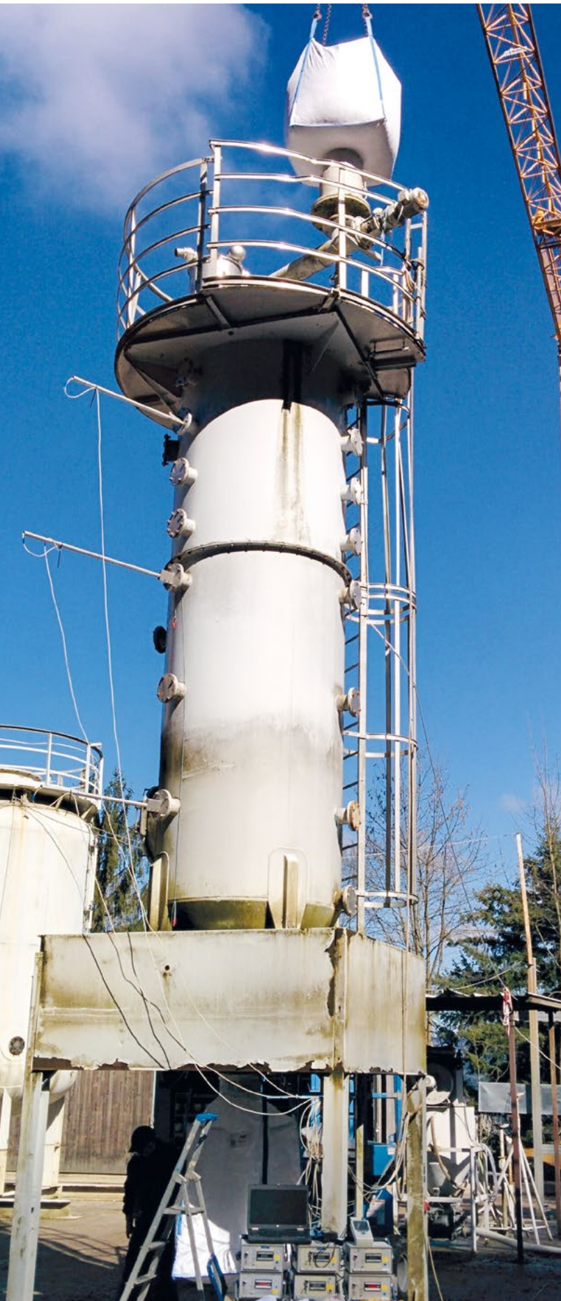
Silo im Realmaßstab auf dem Testgelände in Kappelrodeck im Schwarzwald
