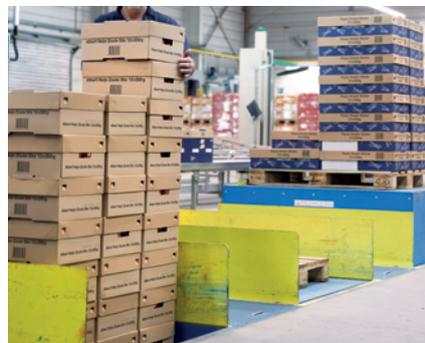
Ist der Einsatz einer im Boden versenkbaren Palettierhilfe nicht möglich, setzen Sie unbedingt einen Scherenhubtisch oder -wagen ein. Dadurch wird tiefes Beugen beim De-/Palettieren der unteren Palettenlagen vermieden.
