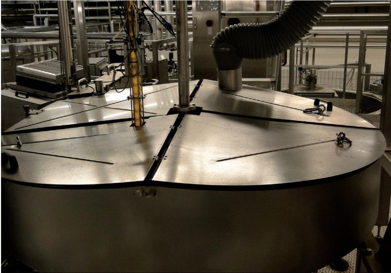
Abb. 6: Geschlossenes Kappenbad mit zusätzlicher Absaugung
