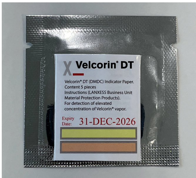
Abb. 3: Überprüfung der Dichtheit der Anlage mittels Indikatorpapiers
