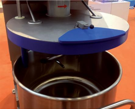
Abb. 4: Bottichabdeckung mit Druckschaltleiste
