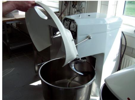
Abb. 2: Knetter mit beweglicher trennende Schutzeinrichtung
