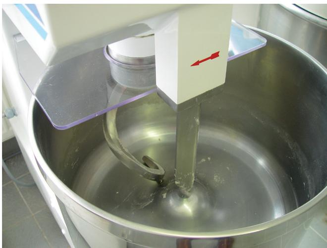
Abb. 1: Spiralknetmaschine
