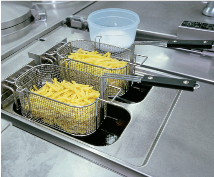
Abb. 4: Fritteuse mit sicher eingehängten Körben
