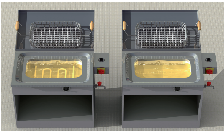
Abb. 3: Schematische Darstellung von Fettbackgeräten. Links: mit Heizeinrichtung über dem Beckenboden, rechts: die Heizeinrichtung ist - nicht sichtbar - unter dem Beckenboden angebracht.
