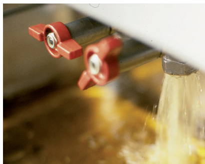
Abb. 7 und 8 Fritteuse mit verdeckter Anbringung der Fettablassvorrichtung
