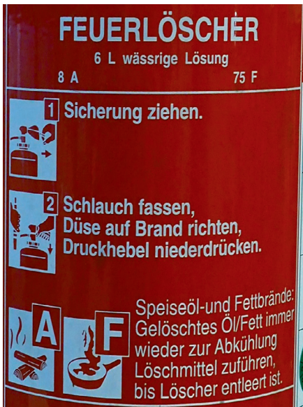
Abb. 10: Kennzeichnung eines Feuerlöschers mit Baujahr ab 2007 nach DIN EN 3 mit dem Piktogramm zur Brandklasse F
