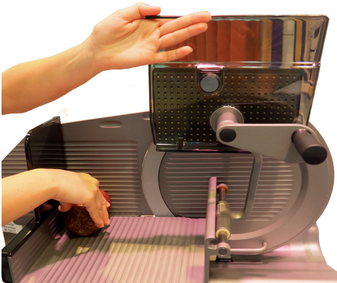
Abb. 7: Das Schneidgut wird bei angehobenem Schneidguthalter und zurückgezogenem Schlitten an die Schlittenrückwand gedrückt
