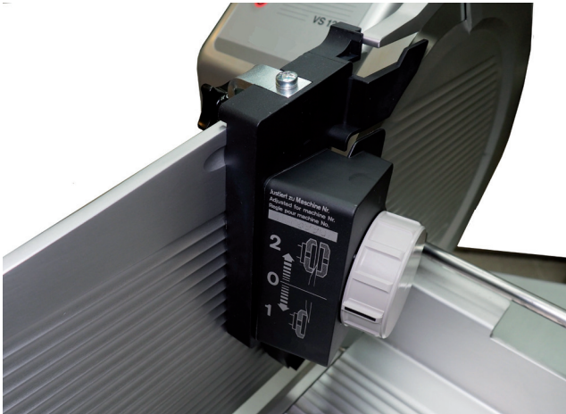
Abb. 5: Aufschnittschneidemaschine mit angebrachtem separatem Messerschleifapparat
