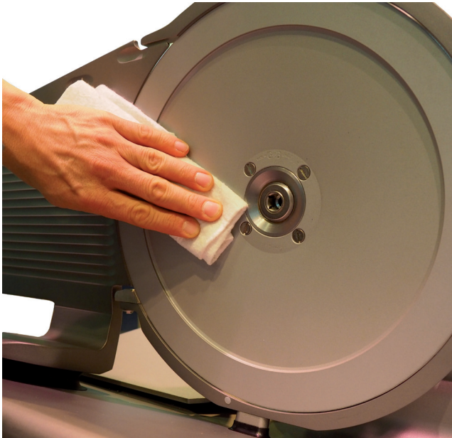
Abb. 9: Beim Reinigen des Rundmessers immer in gerader Linie von der Mitte nach außen putzen.
