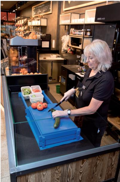
Abb. 21: Schneidbretterhöhung zur Anpassung der Arbeitshöhe
