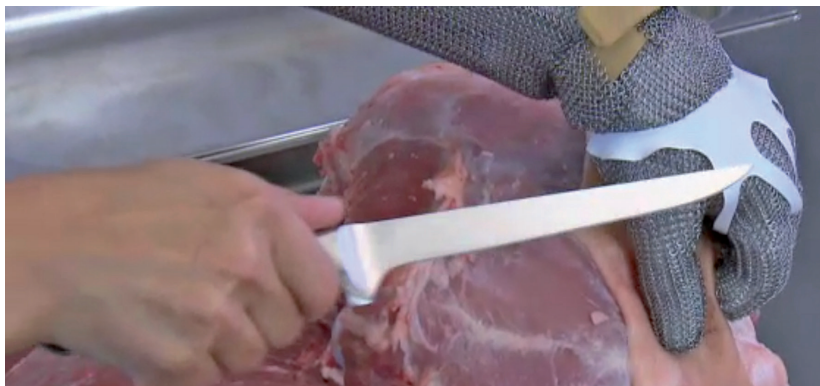
Abb. 12: Ausbeinarbeit mit Stichschutzhandschuh an der nicht messerführenden Hand.
