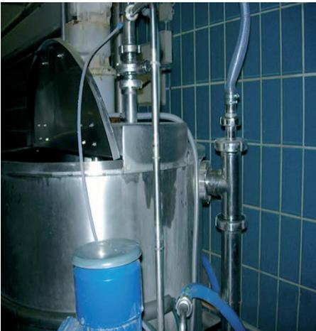
Abb. 3: Wasserstrahlpumpe mit seitlichem Absaugungsanschluss
