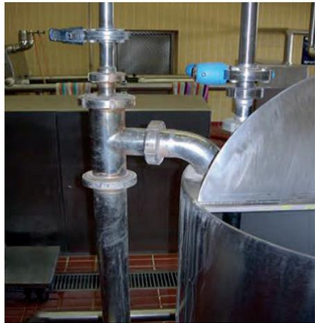
Abb. 4: Wasserstrahlpumpe mit Absaugungsanschluss im Deckel
