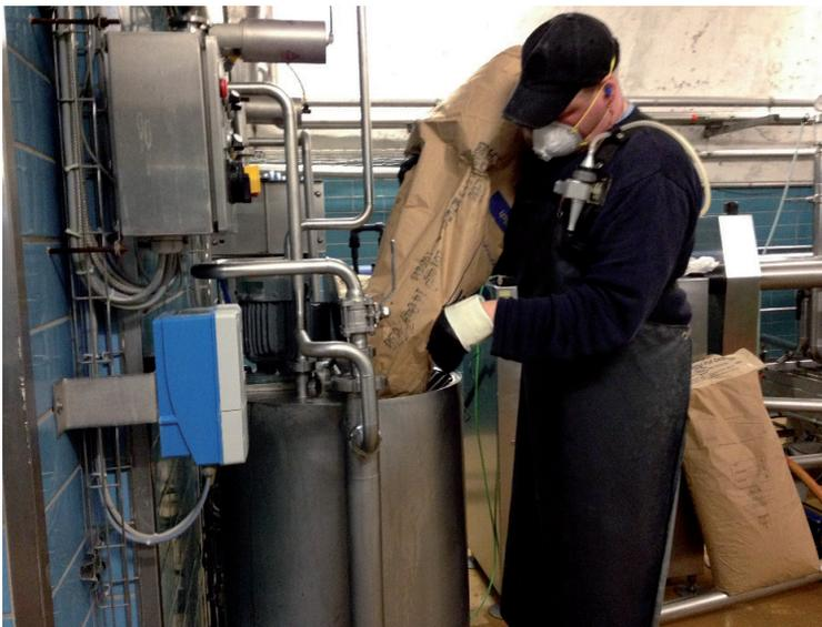
Abb. 10: Personenbezogene Staubmessung bei der Eingabe der Kieselgur
