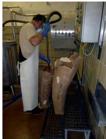
Abb. 8: Arbeiten mit einer Sauglanze in der Praxis
