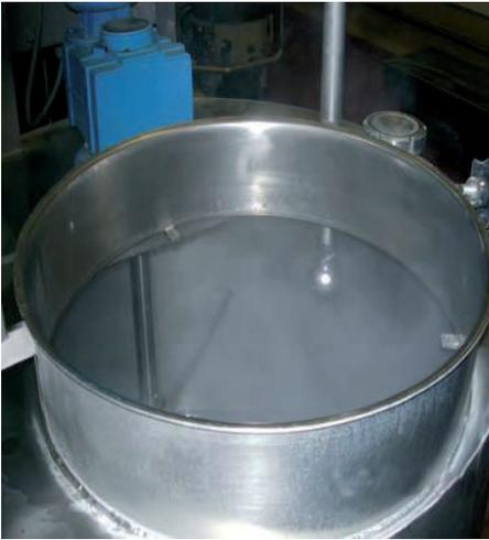
Abb. 5: Dosiergefäß mit Sprühkopf
