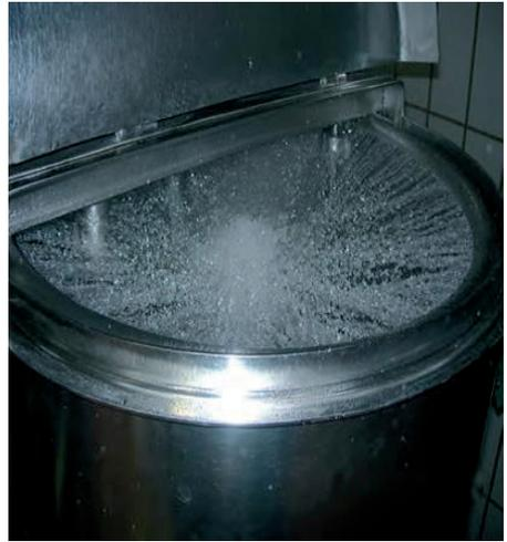
Abb. 6: Dosiergefäß mit Wassereindüsung
