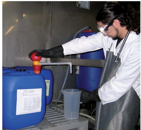
Abb. 3: Handpumpe zur Entnahme aus Kanistern
