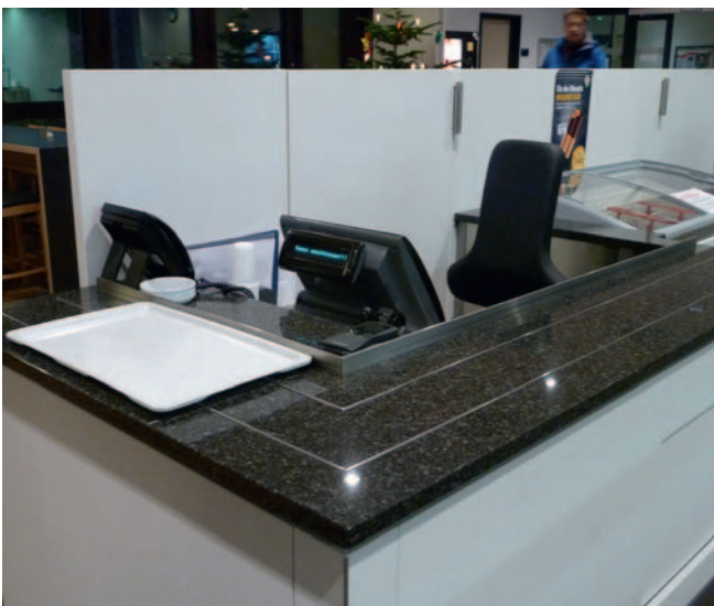
Abb. 16 Ergonomisch gut gestalteter Kassensarbeitsplatz, bei dem ohne Verdrehen des Oberkörpers oder Kopfes gearbeitet werden kann
