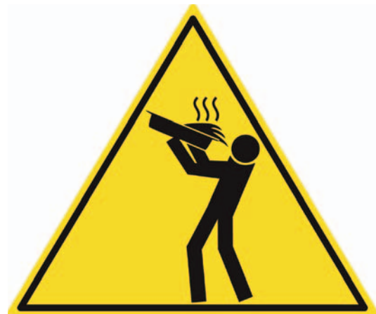
Abb. 13 Warnzeichen Verbrühungsgefahr – in 1,60 m am Heißluftdämpfer anzubringen
