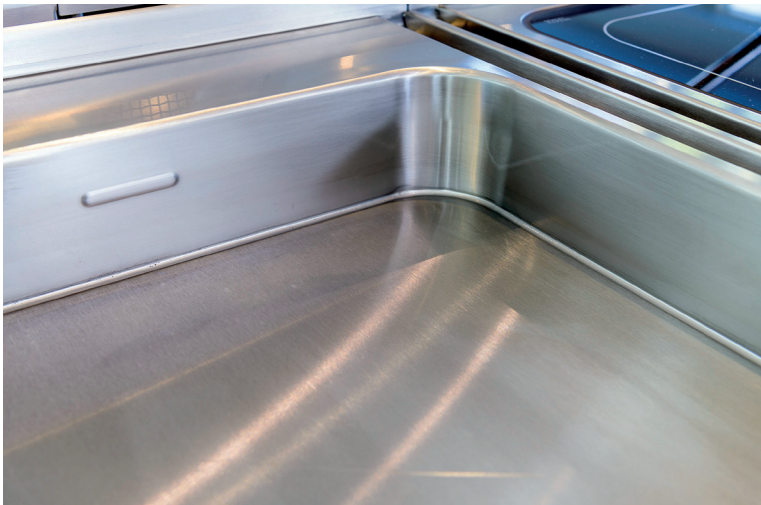
Abb. 4: Griddleplatte mit glänzender Oberfläche (mit freundlicher Genehmigung von MKN, Wolfenbüttel)
