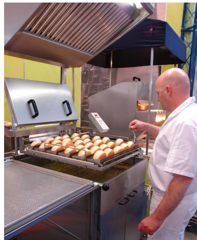
Abb. 10: Abzugshaube am Fettbackgerät, Quelle: ABZ
