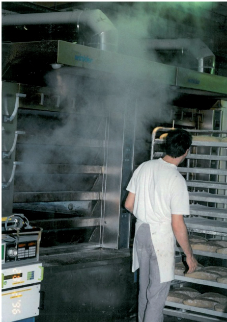
Abb. 9: Unvollständige Erfassung der Wrasen am Backofen
