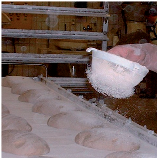
Abb. 6: Auftragen des Backmehls mit einem Sieb
