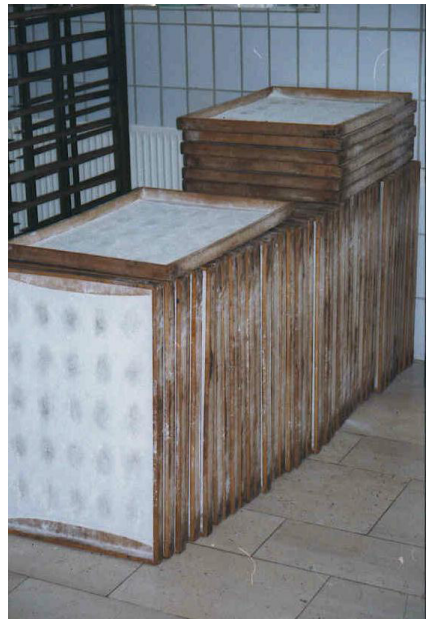
Abb. 15: Falsche Lagerung von Gärgutträgern
