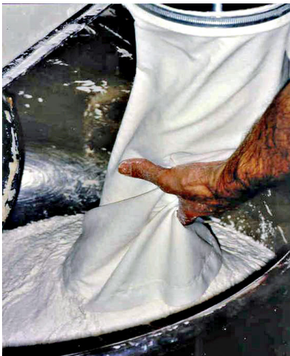
Abb. 3: Eingabe von Mehl aus einer Silowaage in den Knetbottich. Der bis zum Boden reichende Füllschlauch und die Verminderung der Fallenergie durch eine geschickte Führung des Schlauches reduzieren die Staubentwicklung.
