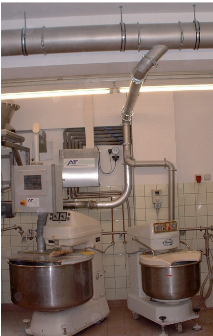
Abb. 24: Mehlstaubabsaugung an einer Knetmaschine
