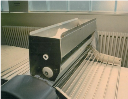
Abb. 7: Teigausrollmaschine mit automatischem Mehlstreuer und einstellbarer Streubreite
