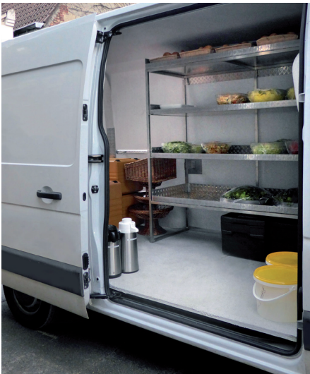
Abb. 9: Innenausbau mit Regalsystem
