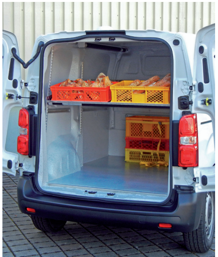
Abb. 10: Laderaumaufteilung durch Zwischenboden
