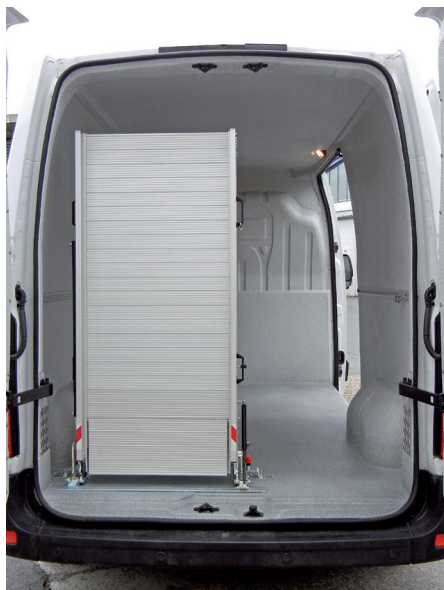
Abb. 5: Manuelle Laderampe zum Ausklappen
