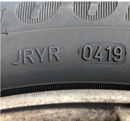
Abb. 3: Der Produktionszeitpunkt ist auf dem Reifen vermerkt. Die ersten beiden Ziffern lassen die Produktionswoche (in diesem Fall die 4. Woche), die letzten beiden Ziffern das Produktionsjahr (in diesem Fall das Jahr 2019) erkennen.
