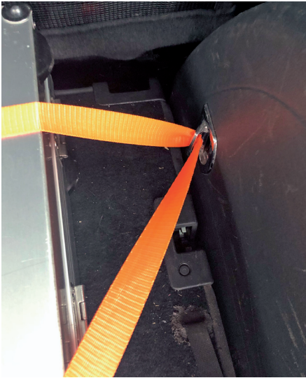
Abb. 11: Ladungssicherung im Kofferraum eines Pkws mittels Spanngurt und Zurrpunkt
