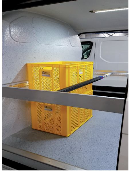
Abb. 8: Ladungssicherung durch Absperrring und Absperrbrett
