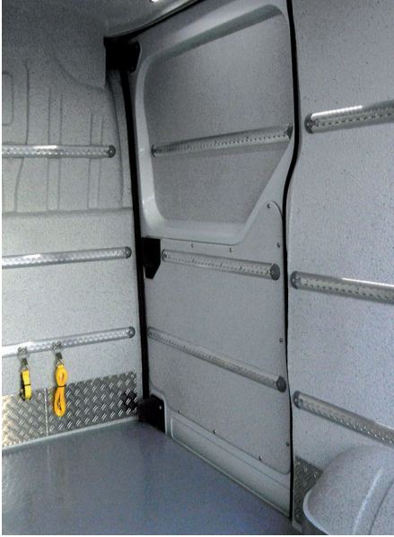
Abb. 7: Innenausbau mit Zurrleisten
